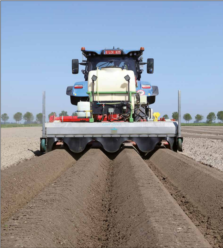
“Het mooie van een Loofdoes is dat je bodemherbiciden op de vochtige net gefreesde grond spuit. Dat is ideaal voor de werking, en dat maakt het ook mogelijk om de hoeveelheid middel te halveren.”
