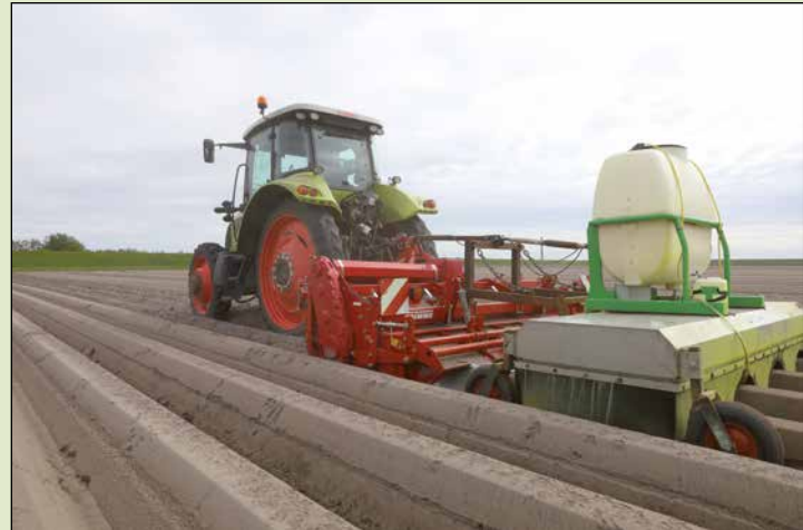
“Wanneer we hier op de lichte zandgronden gaan frezen, droogt de grond hier in een mum van tijd op. De meest ideale oplossing is direct spuiten.” En daarom koppelt AT Texel een Loof-Does achter de rijenfrees.
