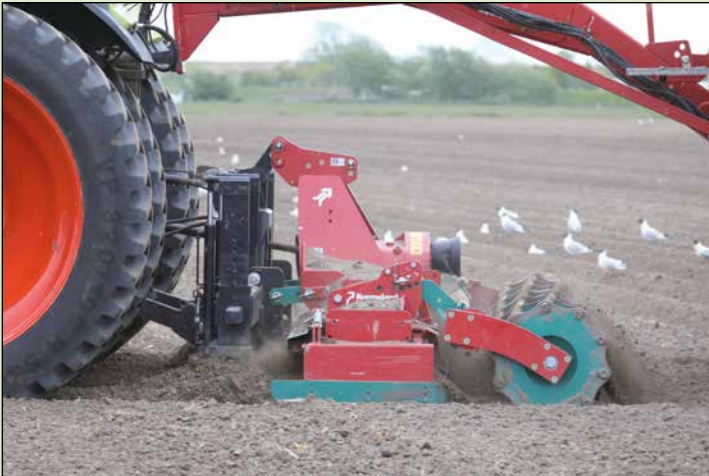
Even de grond optillen met een woeler of paragrubber en verkrumelen met een rotorkoepel is op 90 procent van de Texelse aardappelpercelen al ruim voldoende.
