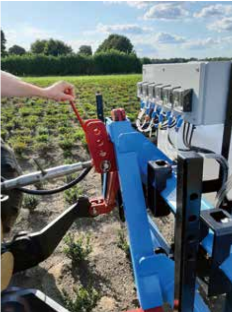
De spuitmachine is met een triangelsysteem opgehangen aan de frontheadrichting van de trekker.
