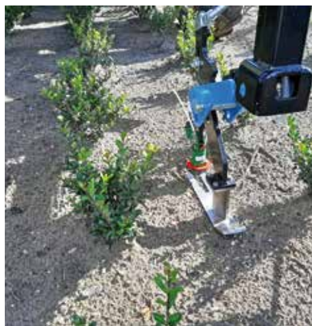
De sleetjes zijn gemaakt van rvs, zodat ze bestand zijn tegen water, bestrijdingsmiddelen en slijtage.
