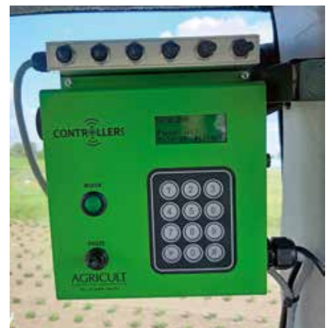
De controller in de cabine, waarmee de strooikoppen onafhankelijk van elkaar aan en uit te zetten zijn.
