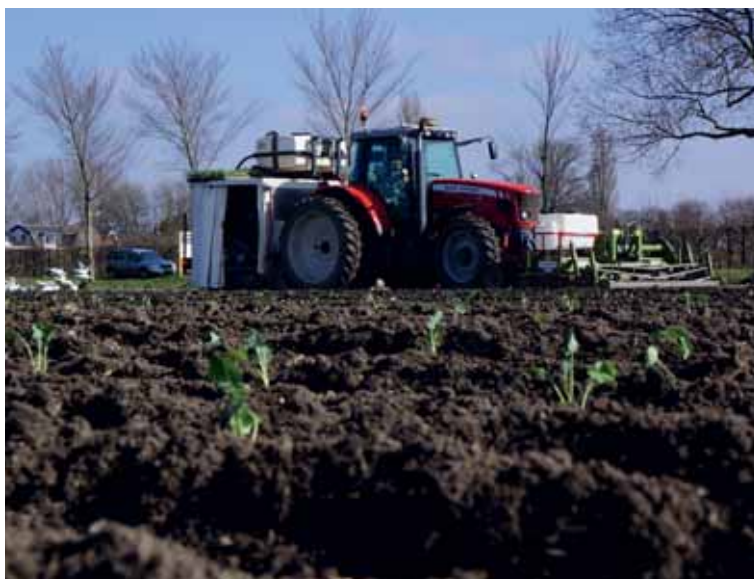
De plantcombinatie van de firma Weel, met de fosfaattank aan de voorkan, en de tank voor vloeibare stikstof op de plantmachine
