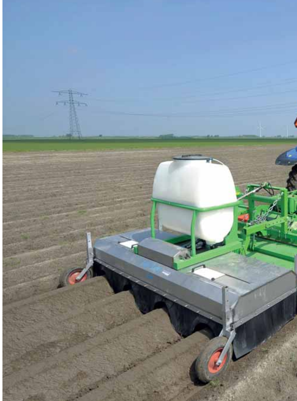
Het principe van de Loof-does bestaat uit elektrisch aangedreven schijfvernevelaars; één per 75 centimeter.
