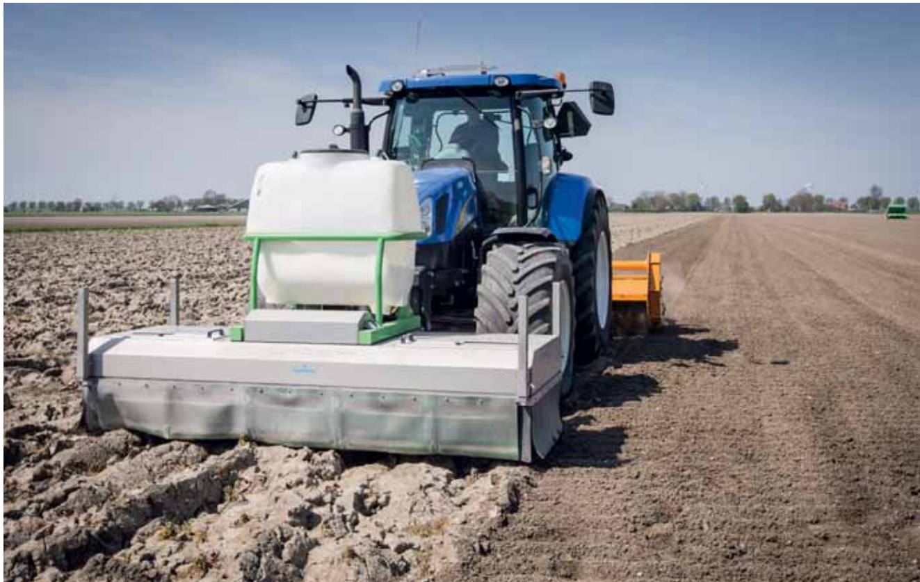
Een gesloten flap rondom is de enige aanpassing om op vlak land een middel netjes vierkant te verdelen.
