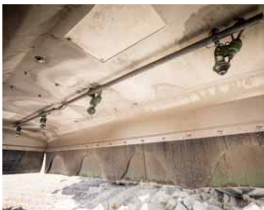
Het principe van de Loof-does bestaat uit elektrisch aangedreven schijfvernevelaars; één per 75 centimeter.
