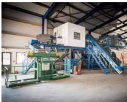
De nieuwe sorteerinstallatie met daarin een Pieper-does, die werkt met de vernevelaars waarmee ook de Loof-does werkt.
